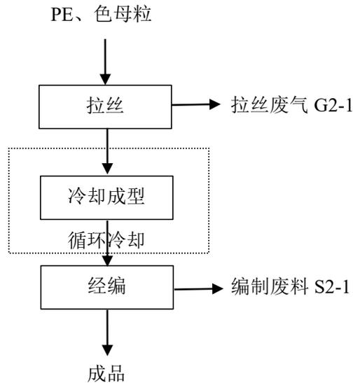
图 2-2 遮阳网生产工艺流程图
