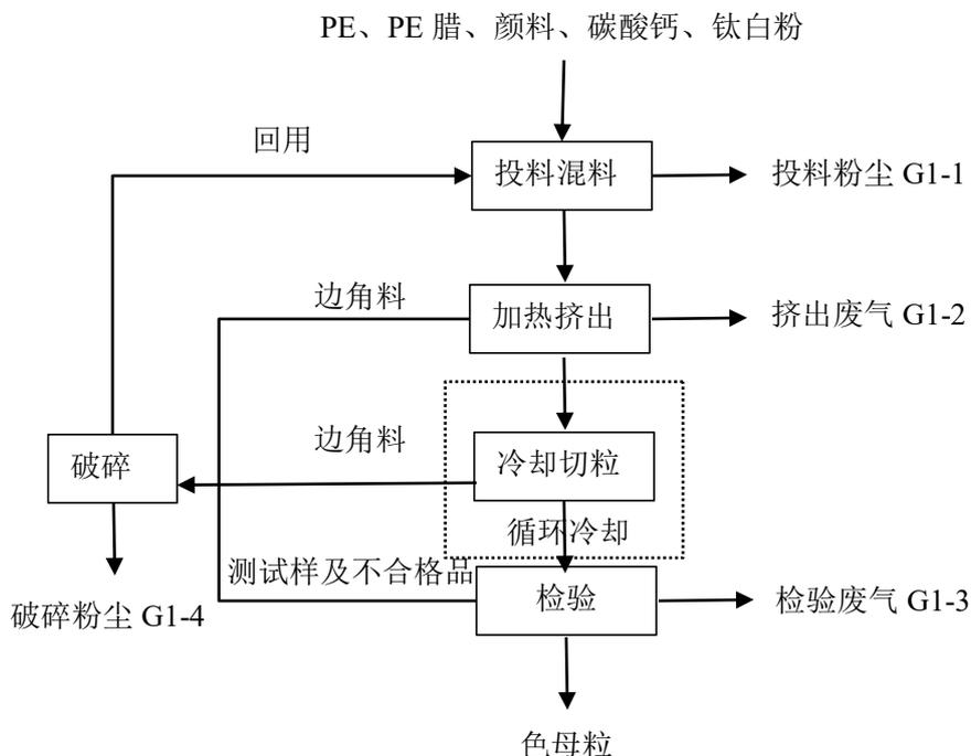
图 2-2 色母粒生产工艺流程图
