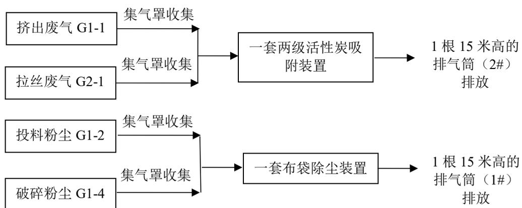
图 4-1 废气处理工艺流程图
