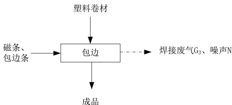
图 2-3 塑料软门帘工艺流程及产污环节图
