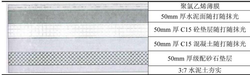
图 4-5 危废仓库防渗结构示意图
