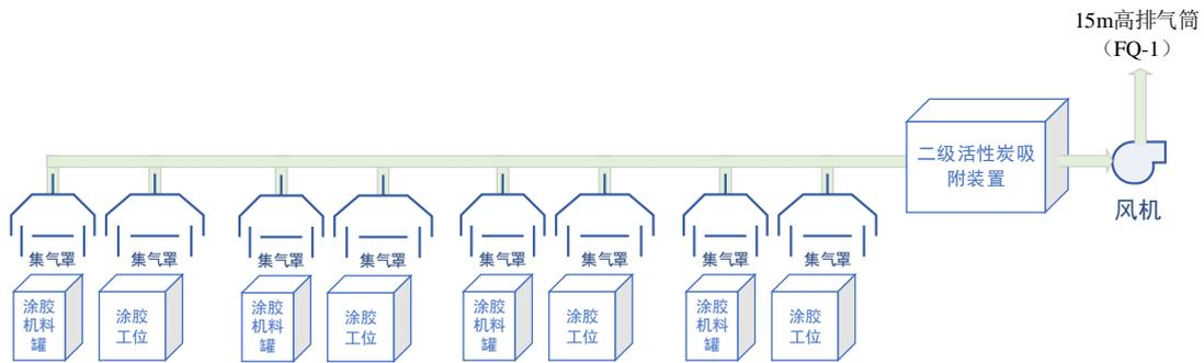
图 4-1 本项目废气收集处理流程示意图
