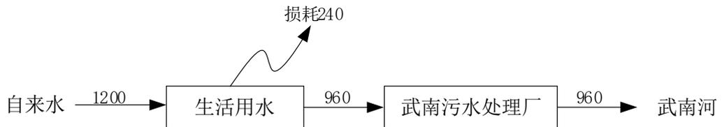
图 2-1 本项目水平衡图（单位：t/a）
