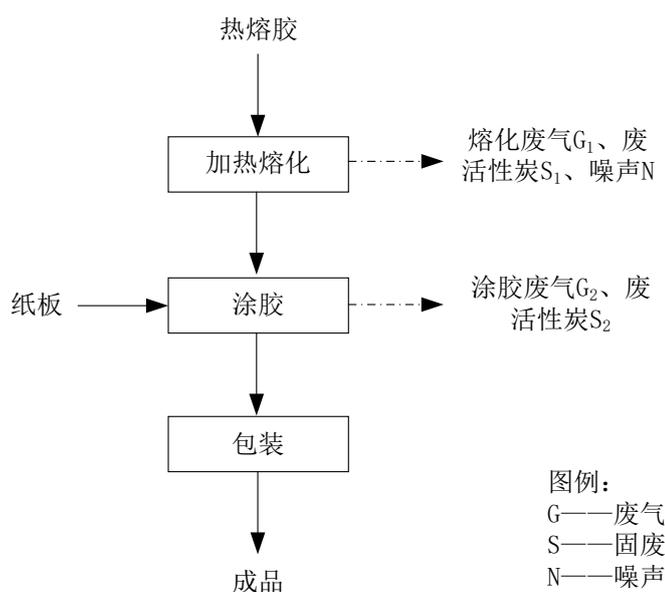
图 2-2 捕鼠板、捕虫板工艺流程及产污环节图
